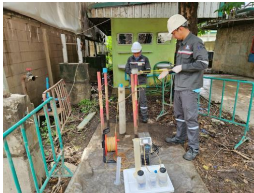
บ่อ Monitoring Well บริเวณระบบบำบัดน้ำเสีย
